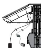
3. Acheminez le fil téléphonique à travers l'ouverture du support d'installation murale et branchez-le dans la prise téléphonique. Acheminez le fil du cordon d'alimentation du socle et branchez-le dans une prise de courant qui n'est pas contrôlée par un interrupteur.
